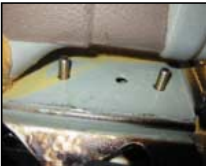
Anbau der AHK
